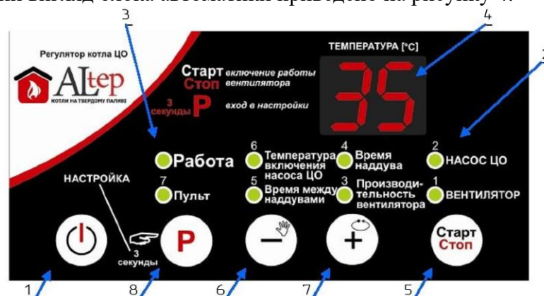
Рисунок 4 – Зовнішній вигляд передньої панелі контролера
